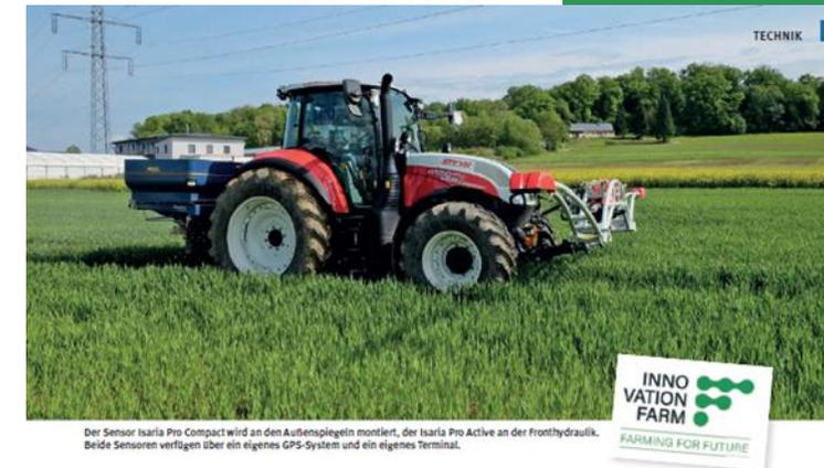
Der Sensor Isaria Pro Compact wird an den Außenspiegeln montiert, der Isaria Pro Active an der Fronthydraulik. Beide Sensoren verfügen über ein eigenes GPS-System und ein eigenes Terminal.
