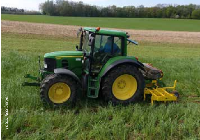
Der „Ground Cutter“ der Fa. CFS ermöglicht die Unterschneidung der Gründedecke ohne vorheriges Mulchen (links). Fast intakte Gründedecke nach dem Umbruch (rechts)
