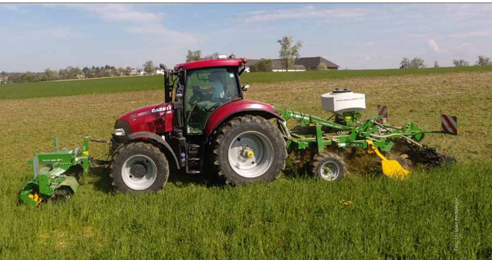
Sternradgrubber Kerner Corona, ausgestattet mit Striegelwalze und Stützrädern, Kerner X-Cut solo im Frontanbau.
