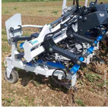
Die patentierte hydraulische Bandbreitenverstellung bei Hackgerät von SAMO ermöglicht eine Anpassung an wechselnde Bedingungen während der Fahrt.
