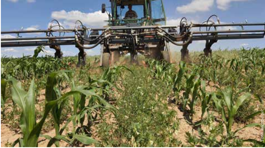
Der Zwischenreihenmulcher von Rohringer & Rossak im Einsatz am Projektstandort Gaubitsch bei Laa/Thaya.
