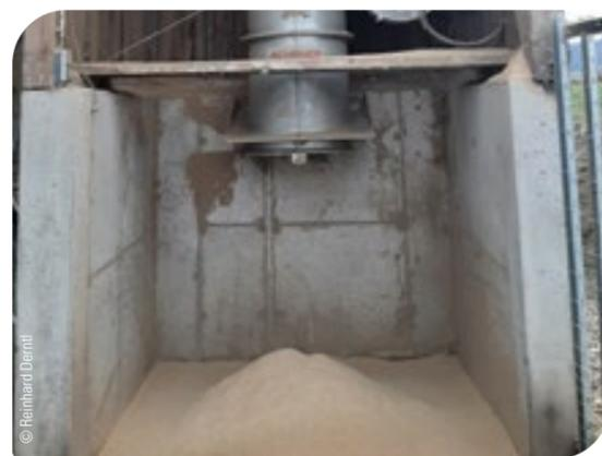
Abb. 131: Strohmatic Air – Entstaubung
