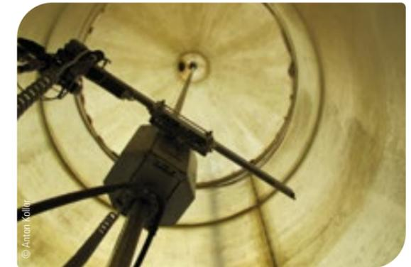
Abb. 38: Silo immer wieder komplett leeren und mit einem Spezialgerät reinigen, desinfizieren und trocknen lassen.
