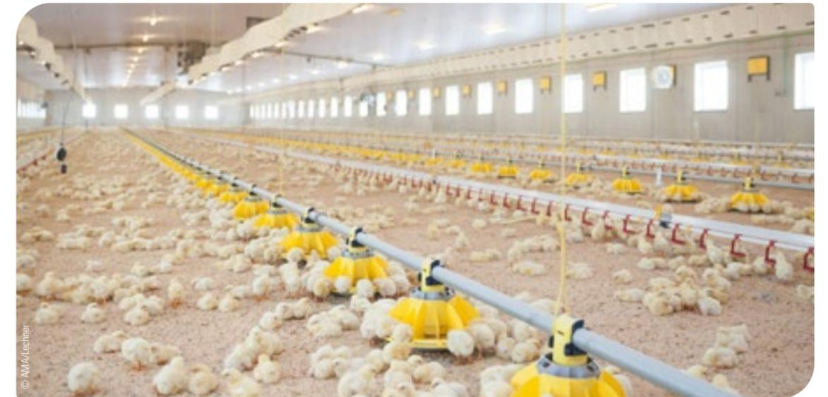
Abb. 11: Die Verteilung der Fütterungs- und Tränkanlagen muss sicherstellen, dass alle Tiere ungehinderten Zugang haben.
