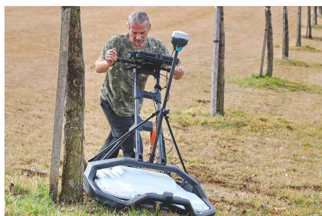
Abb. 8: Non-invasive Wurzeluntersuchung mittels Wurzelradar an achtjährigen Sämlings-Birnbäumen (OIKOS, März 2025).
